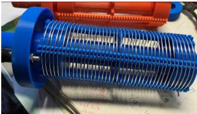
⑫コイル上部は、写真のようにロッドアンテナに接続する目玉クリップ（ダイソーなどでお求めください）、コイルのタップ調整（ミノムシクリップまたは IC クリップ）のリード線を接続
