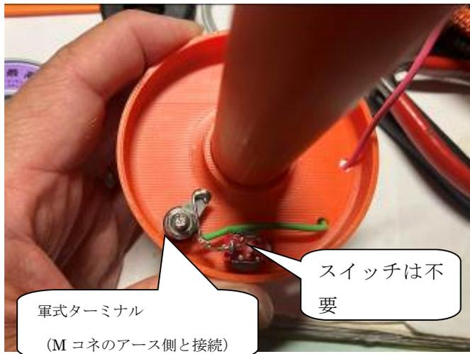
⑪コイルを差し込んで接着剤で固定。コイルの下側と M 型コネクターの芯線からのリード線を接続します
