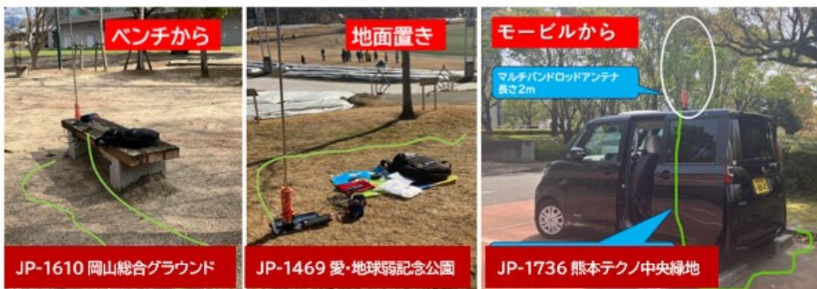
写真 8: 製作した万能基台は、POTA 移動の3パターン
