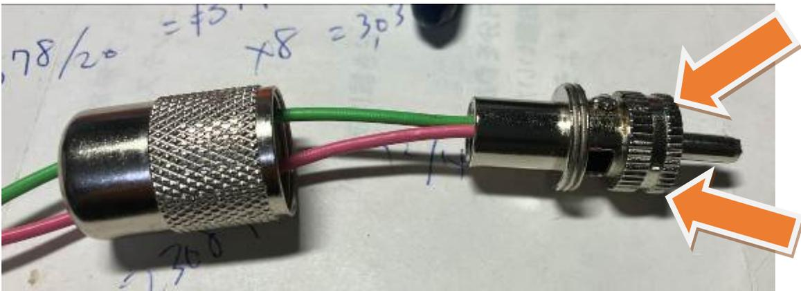
⑨M型コネクタの外側と中側のアース部分を半田付け、その後主軸に接着剤で固定します
