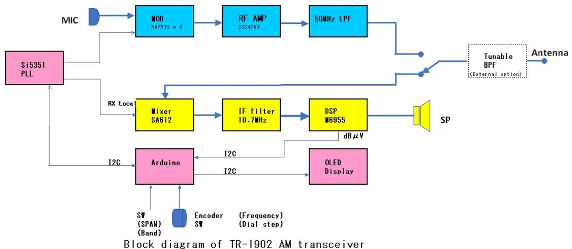
一つの PLL から、送信キャリア、受信ローカル信号、および DSP クロック信号の周波数を発生させています。
