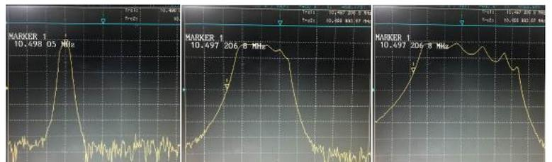
CW フィルタ特性 500Hz      SSB フィルタ特性 2.4kHz      AM フィルタ特性 6kHz
