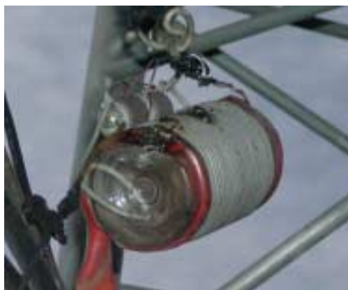
写真 1 燃えて火の粉が空から降ってきた昔の 3.5MHz コイル
